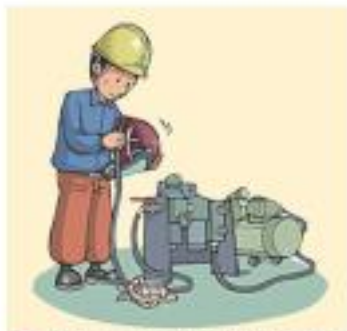
3 중압호스를 유압조정장치 및 여과장치에 연결하고 연결관을 인연부 및 유량조정장치에 연결
