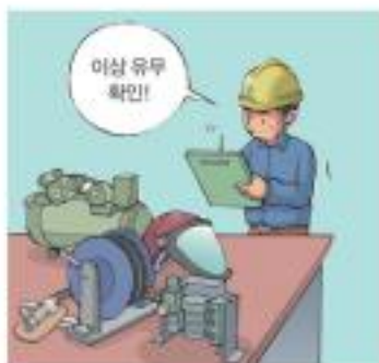
1 압축공기 공급원, 중압호스, 유량 조절 장치, 인연부 등의 이상 유무를 확인
